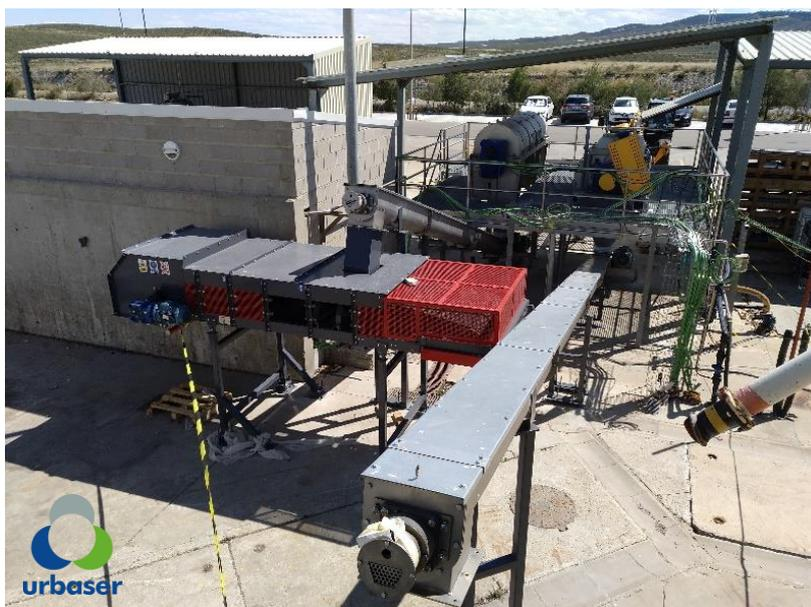
Figura 7. Prensas para la deshidratación del digestato.
